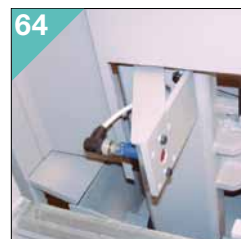
Laser di intestatura automatica. Laser detection for automatic trim cut.
