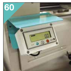
Visualizzazione angolo di taglio tramite display lcd. Angle digital display.
