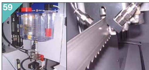
Impianto per lubrificazione minima. Minimal lubrication system.
