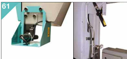
Laser di tracciatura. Laser ray.
