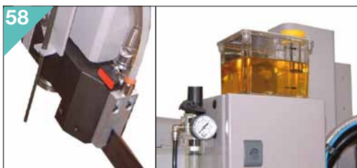
Impianto per lubrificazione minima. Minimal lubrication system.
